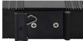
Per montare la staffa a parete, il kit guida DIN viene sostituito dalla staffa di montaggio
