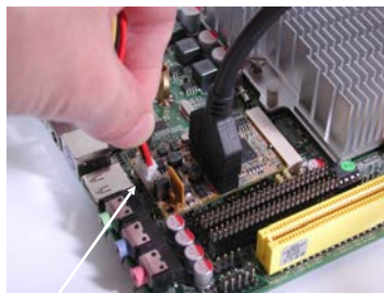
Cavo ausiliario di alimentazione per l'alimentazione del bus USB (controllare le impostazioni JP1)
